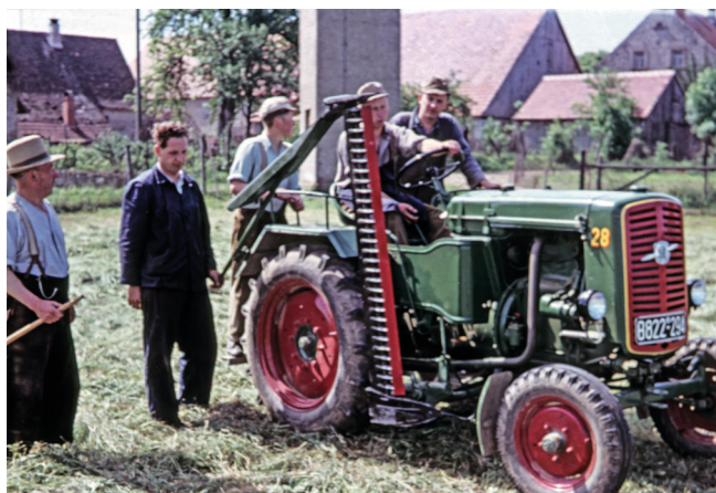
Der erste Traktor der Markerts, ein HELA mit 28 PS-Dieselmotor, 1950er. Inv.-Nr. Glch-00018
